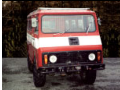
Die modifizierte Version der L33-Modelle fand man ab Mitte der 70er Jahre mit dem in Ungarn bei Ungarocamion gefertigten Volvo C202.
